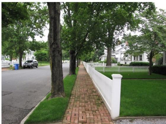
Figura 85 – Modelo de calçada verde com uma faixa de canteiro
