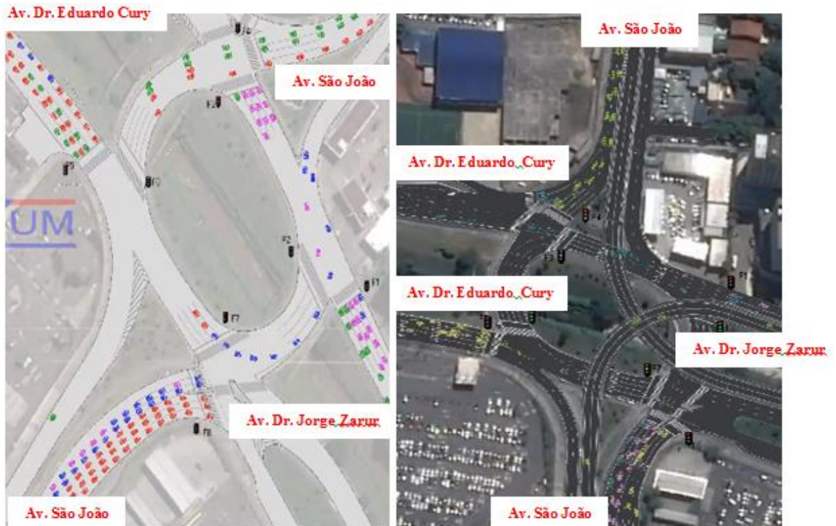
Fig. 6 – Simulação de tráfego – Ponte Estaiada: fator de garantia da fluidez do tráfego
