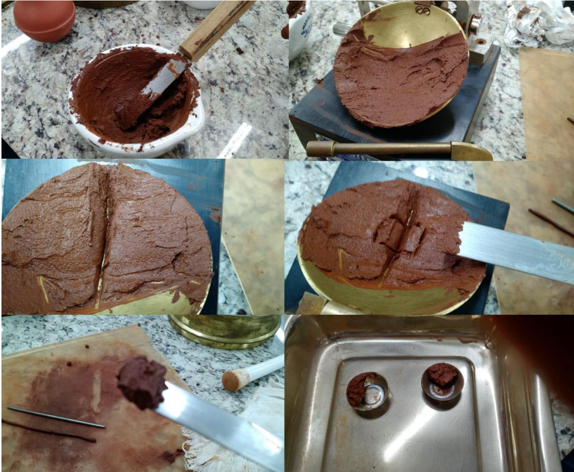
Figura 43- Mosaico de Procedimentos de Determinação do Limite de Liquidez
