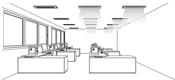
Figura 31 .Exemplo de ambiente com a fileira de luminárias próxima à janela apagada, enquanto as demais luminárias estão acesas.
