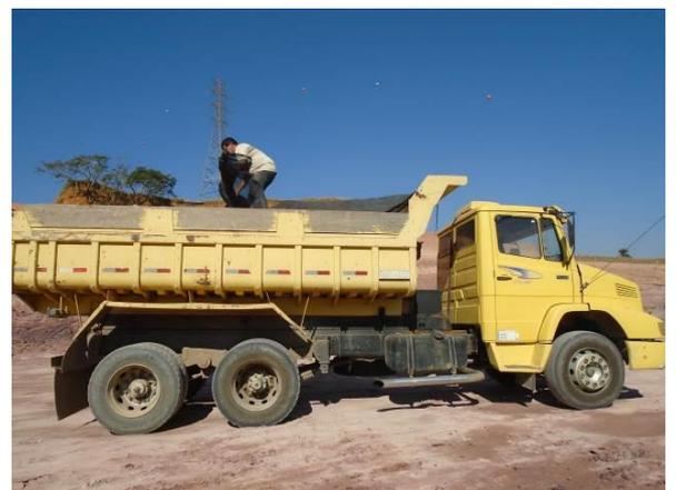
**Figura 46 - Caminhão de obra com caçamba coberta por lona, visando a redução da queda de materiais térreos nas vias.**
