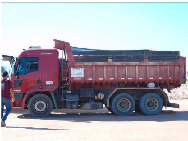
**Figura 45– Caminhão de obra com caçamba coberta por lona, visando a redução da queda de materiais térreos nas vias.**
