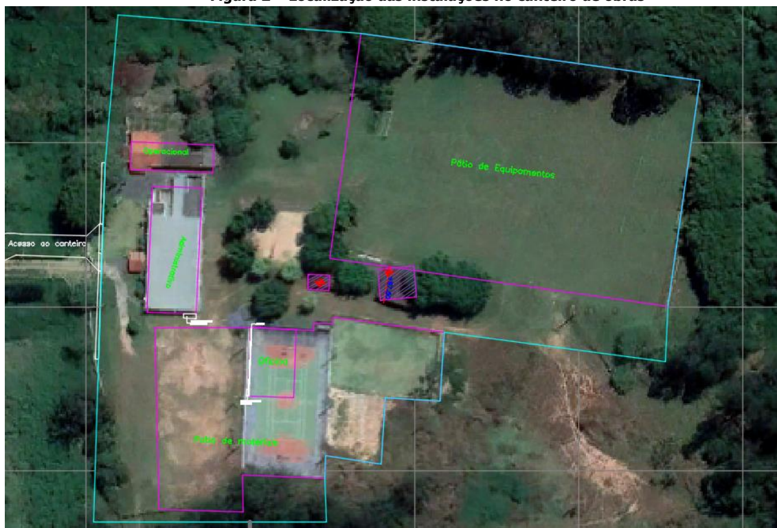
Figura 2 – Localização das instalações no canteiro de obras
